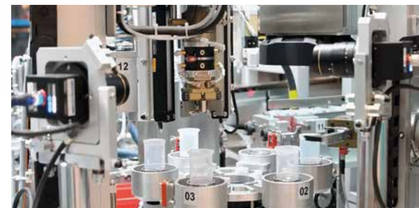
Le parti della siringa Enfit che vengono assemblate. La fase di alimentazione e controllo del corpo della siringa.
