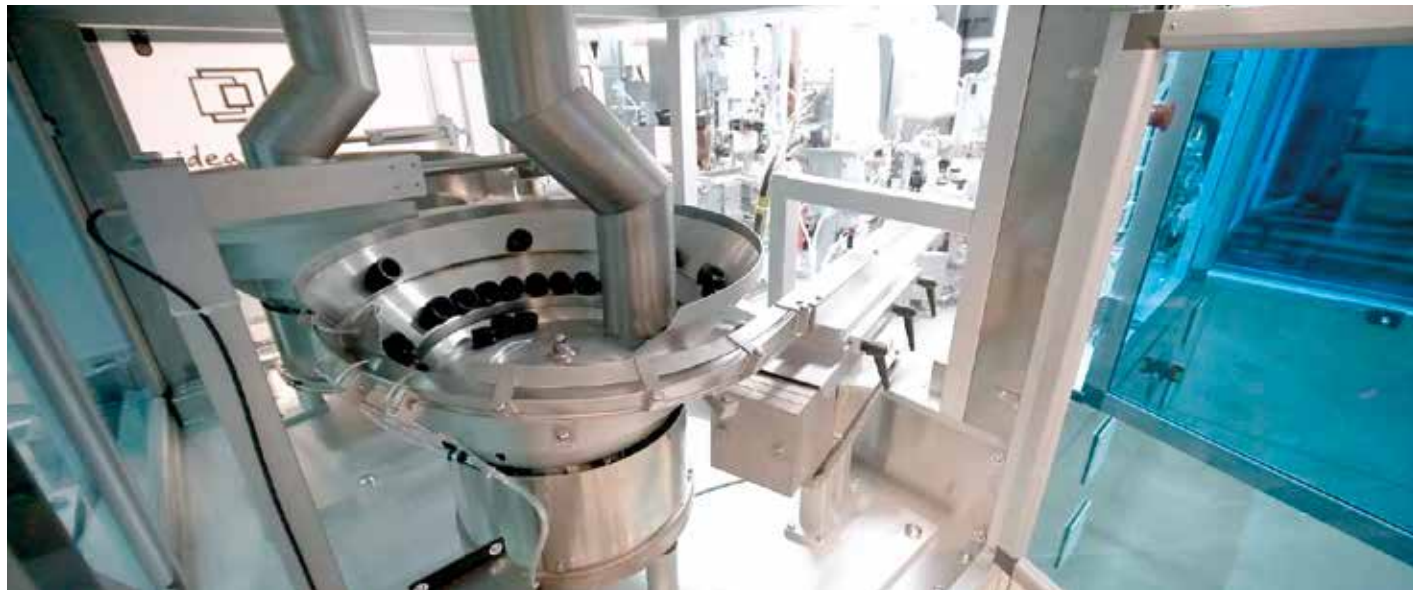
Alimentazione, pulizia e controllo del pistone
