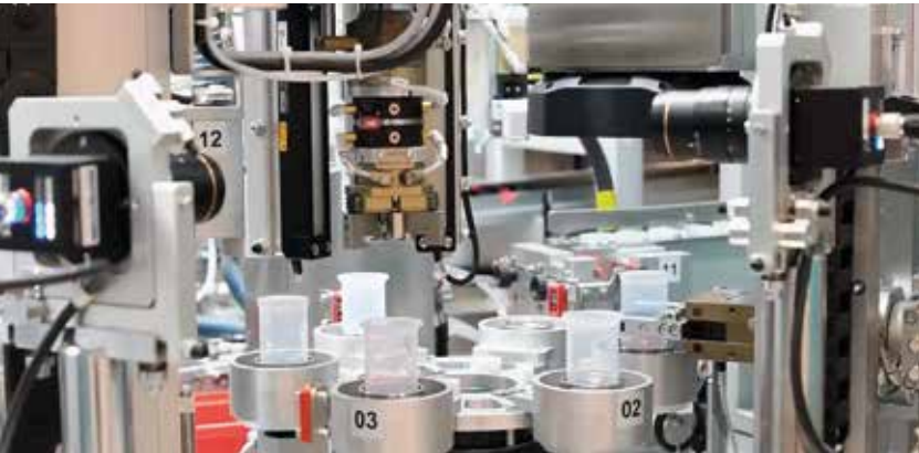
Alimentazione, pulizia e controllo del pistone
