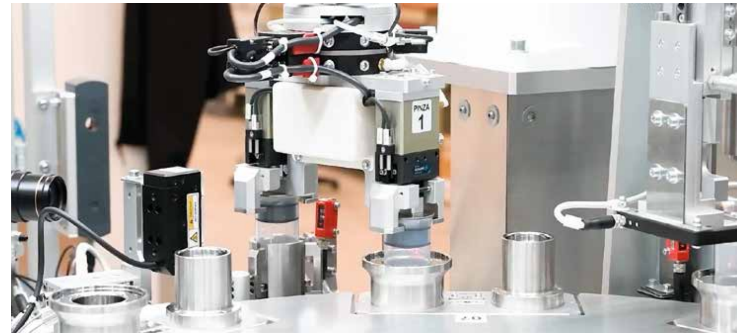
Controllo superiore e inferiore del pistone, controllo e scarico dell'assemblato e ciclo di pesatura.
