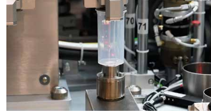
Controllo superiore e inferiore del pistone, controllo e scarico dell'assemblato e ciclo di pesatura.
